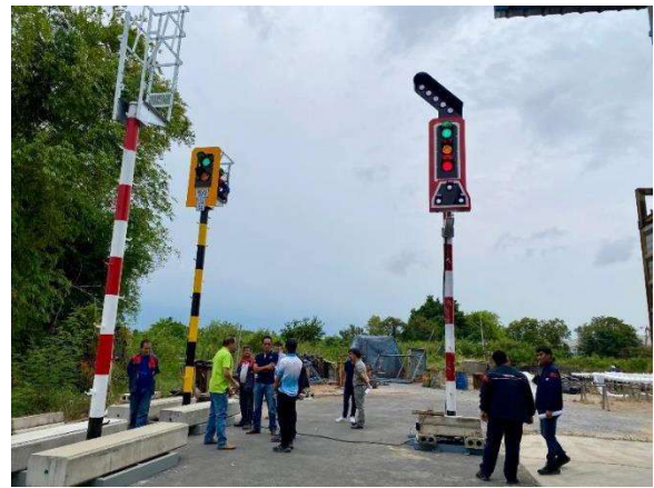
ดำเนินการตรวจสอบ FAT อุปกรณ์ Colourlight Signal
