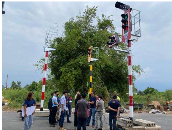
ดำเนินการตรวจสอบ FAT อุปกรณ์ Colourlight Signal
